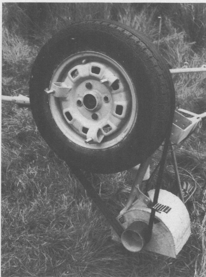
Riemengetriebe: Autorad und vernähter Sicherheitsgurt. Fahrradnabe als Pendelgelenk, Langlöcher zum Ausrichten.
