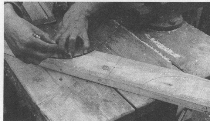
Übergang: mit gebogenem Draht als „Lineal“ anzeichnen
