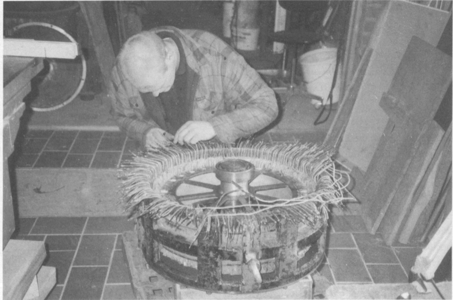
Wolfgang Schwarz beim Bau eines 58-poligen Dauermagnetgenerators (220 V bei 35 U/min)
