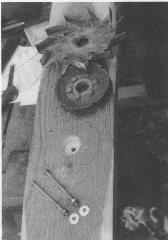
Riemenscheibe auf den Repeller abgezeichnet, 2 Löcher für zu dünne Schrauben und Senkung fürs Ende der Achse gebohrt.
