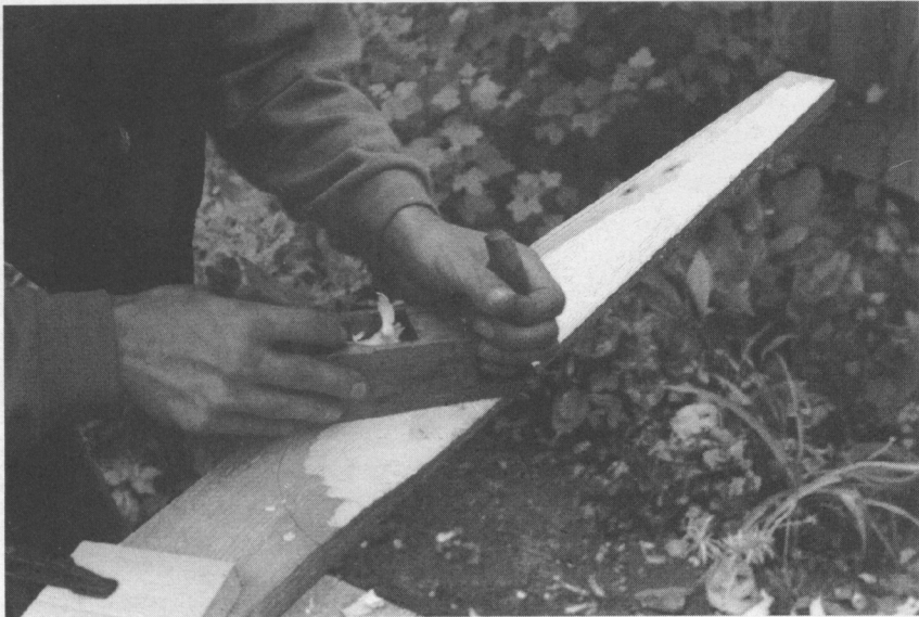
Luvseite vorhobeln: Arbeitsrichtung so, daß es nicht ins Holz reißt!
