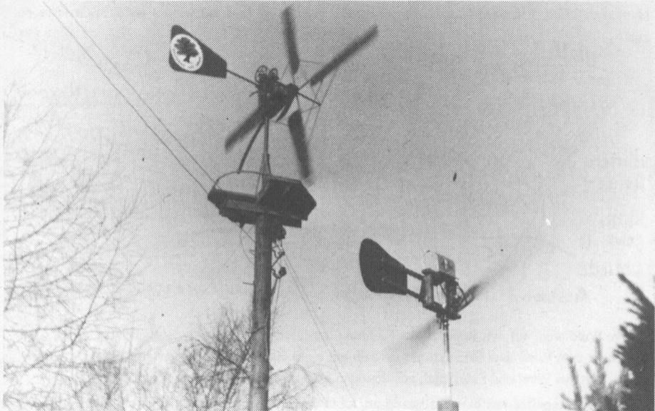
Sofingen wir an: 2 Sperrholzflügel, Keilriemen (Einbandbild, 1977), 4 Sperrholzflügel, 2-stufiges Ketten- getriebe, normale LiMa (1978/79, links), aerodyn. Repeller, 1-stufig Kette, Sturmsicherung (rechts, 1979/80).
