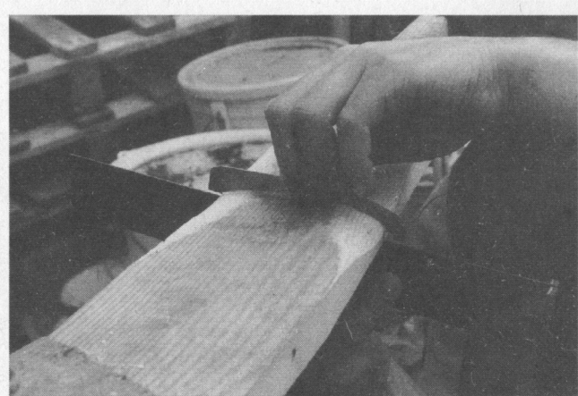
Profil 1 prüfen: noch nicht fertig
