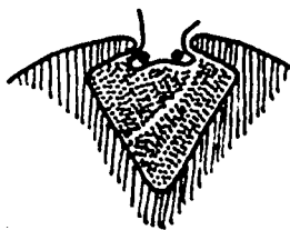
Beide Wicklungen fertig, Verschlußstreifen eingelegt, Wicklung einmal abgebunden.
