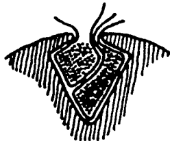
Zweiter Isolierstreifen eingelegt, zweite Wicklung in der Nut.
