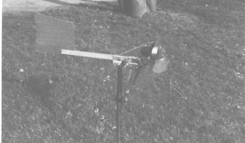
Einfache Helikoptersicherung, Betriebsstellung. Anschlagpuffer: um Stoßdämpferstange gewickeltes Gummi, Draht drum. Winddruckschalter-Anschlag am Stoßdämpfer. Klappt in Sturmstellung weiter nach hinten u. schaltet ab, s. S. 61.
