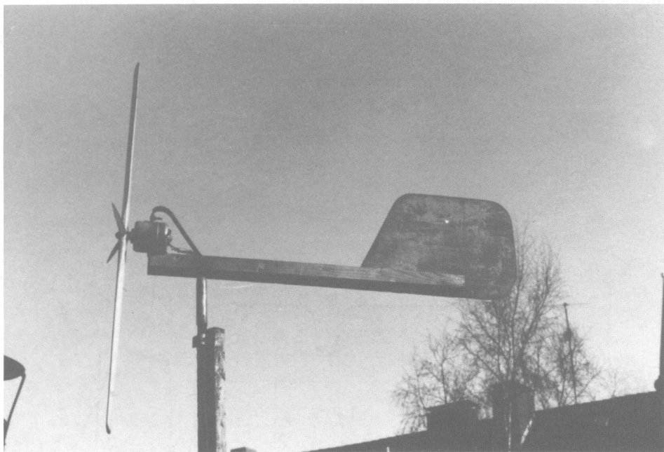
Diese Ansicht läßt die übrigen Einzelheiten erkennen. Das Kabel geht durch das Mastrohr.
