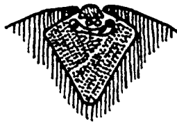
Verschlußstreifen zugefaltet, Wicklung zum zweiten Mal abgebunden. Nut mit Halbrundholz verschlossen.
