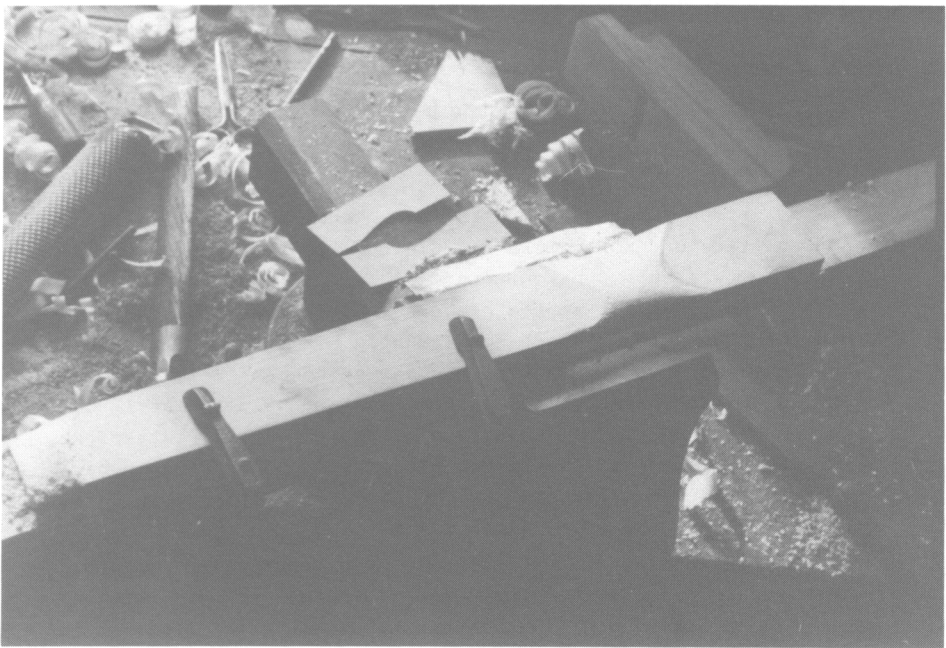
Profil am Ende und nahe der Nabe nach Schablone geraspelt.
