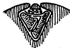
Wicklung abgebunden, Nut mit Halbrundholz verschlossen.
