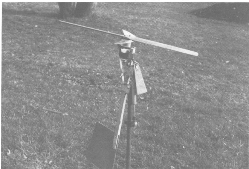
Sturmstellung. Schelle zur Befestigung des Stoßdämpfer-Gelenkes am Mastdrehlager-Rohr aus 2 Stückchen Vierkantrohr mit zum Mdl.-Rohr passend halbrund gefeilten Aussparungen gebastelt.
