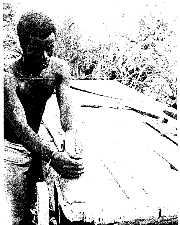
Fig.201 On sciera la planche selon le contour tracé. Une scie à chantourner est préférable pour ce travail, mais plusieurs charpentiers se servent d'une scie ordinaire
